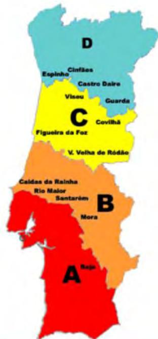
Figura 7.5.1 | Carta de Zonamento Sísmico (RSA, 1983, in ANPC (2010)); ○ - AI do PP Fonte da Telha.
