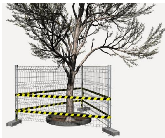
Fig. 2 – Exemplo de estrutura para proteção de árvore através de cercas móveis de 3,50x2,00 m, formadas por painel de malha electrossoldada e postes verticais de 40 mm de diâmetro, acabamento galvanizado, colocados sobre bases pré-fabricadas de betão fixadas ao pavimento.
